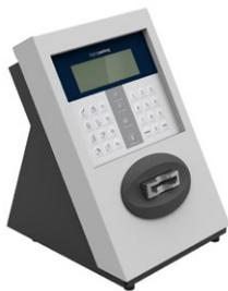
**Pour un traitement efficace des tickets.** Avec le Monocard4 Online Coder, les fonctions les plus importantes pour la modification des tickets sont réunies dans un appareil compact. Les fonctions fréquemment utilisées, comme par exemple le «remplacement d'un ticket perdu» ou la «création d'une sortie gratuite», peuvent être attribuées à des touches fixes. Toutes les manipulations sont enregistrées.
